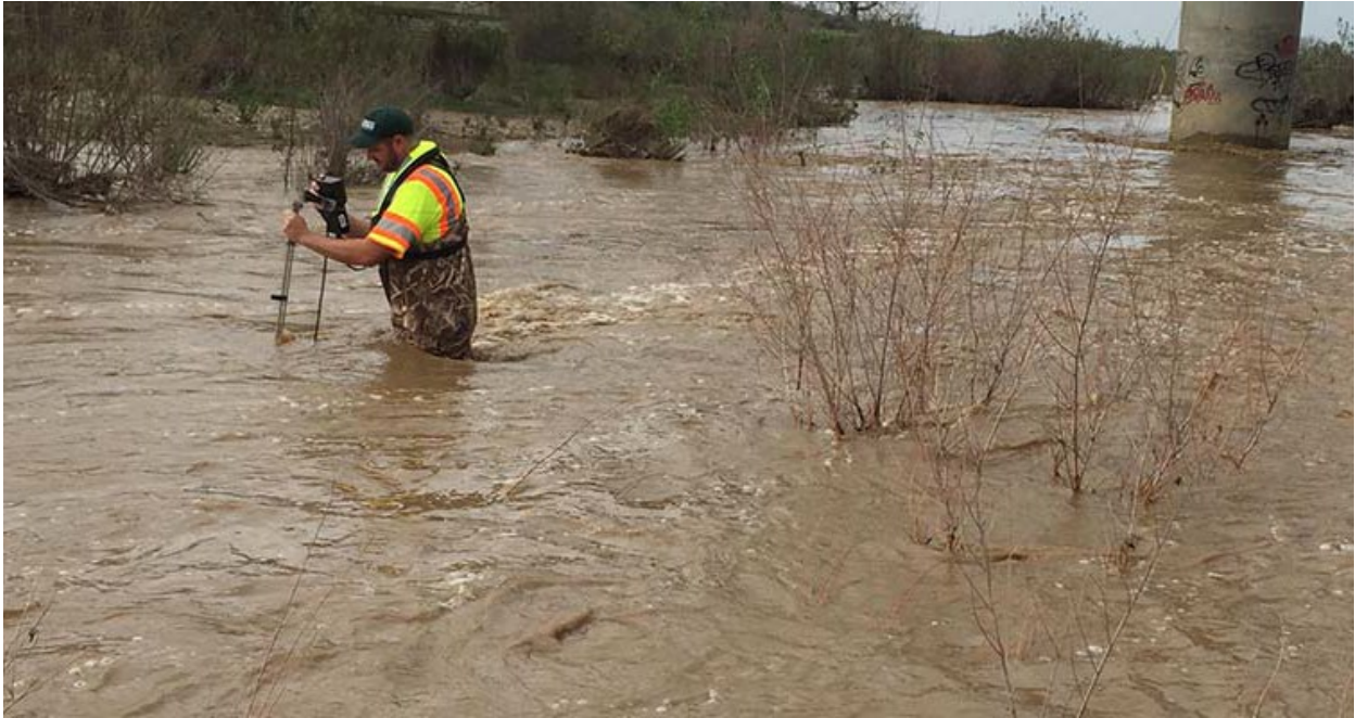
El técnico del Servicio Geológico de los Estados Unidos (USGS) mide el caudal de los ríos en el río Santa María. Crédito: USGS
